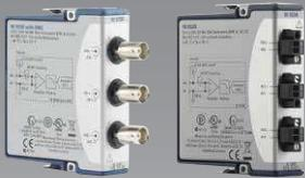
**NI 9230:** Módulo de Entrada de Sonido y Vibración de la Serie C, 3 Canales, 12.8 kS/s/canal,  $\pm 30$  V. BNC o bornera.
