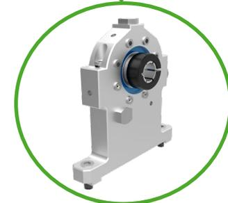
**Chumaceras bipartidas** para montaje rápido de ejes. El mecanismo para instalación de rodamientos, no requiere de prensas, calentamiento, ni golpes para su correcta instalación.
