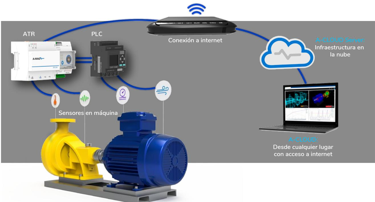
El proyecto se encuentra en trámite y consiste en **instalar sensores en los puntos más críticos** y **monitorear continuamente la máquina (24/7)**, con el fin de obtener datos por medio de ondas, espectros, tendencias y demás gráficas que alerten e indiquen al personal de planta sobre una potencial falla que pueda generar paros indeseados en la máquina.
